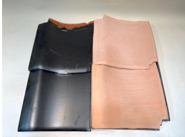
圖 19 傳統屋瓦（左）與自製香灰屋瓦（右）外觀比較
