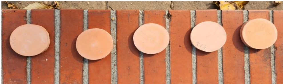
圖 6 自然風乾、日照曝曬之屋瓦實驗示意圖
