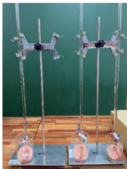
圖 3 模擬酸雨逕流實驗裝置
