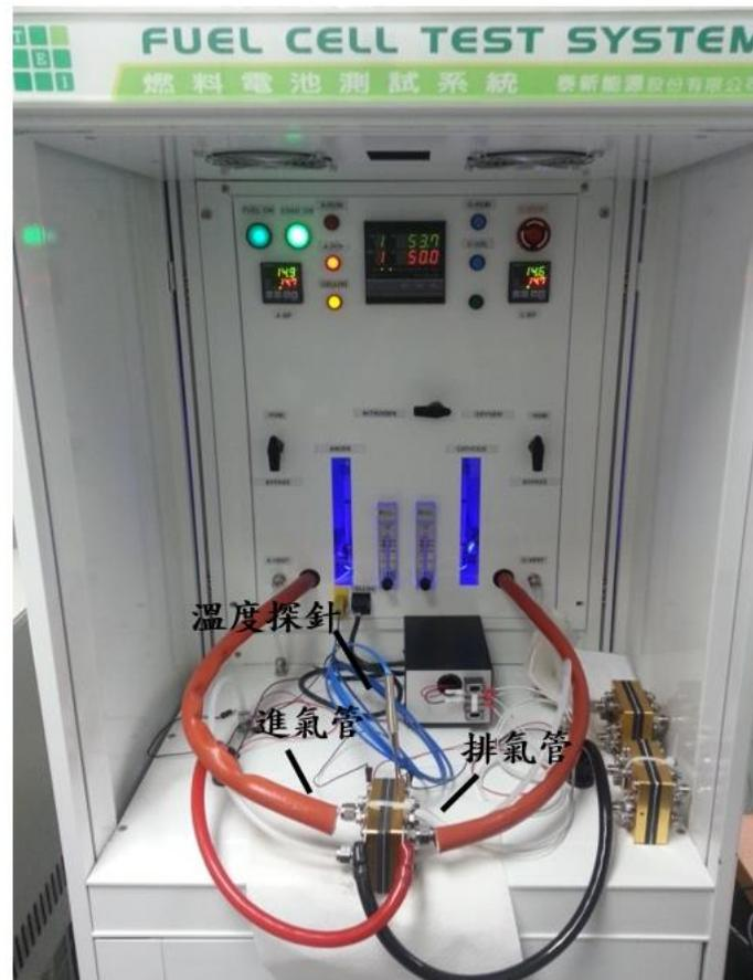
圖二十九、燃料電池測台
