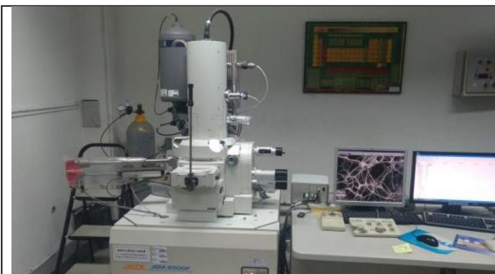
場發射掃描式電子顯微鏡 (FSEM)
