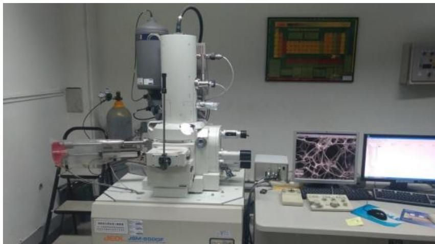
圖十二、場發射掃描式電子顯微鏡儀器圖。
