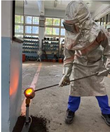
圖 13 將鑄鐵液倒入熱電偶澆口杯
