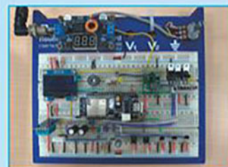
▲ 零件安裝到麵包板進行測試
