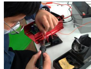
圖 26 輸出端架接到逆變器電源開關
