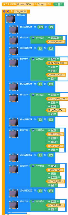
圖 37 OLED 液晶面板顯示數據程式
