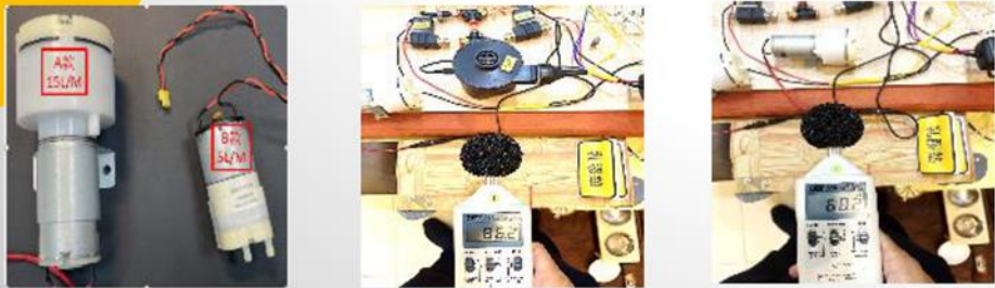
將原本的充排氣置換為真空幫浦，噪音值下降18dB
