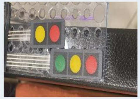
b.改良使用薄膜按鈕，並將控制板安裝於電機旁，可以節省大量空間
