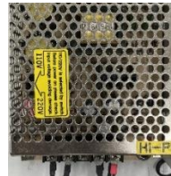
圖（3）AC-DC 變壓器
