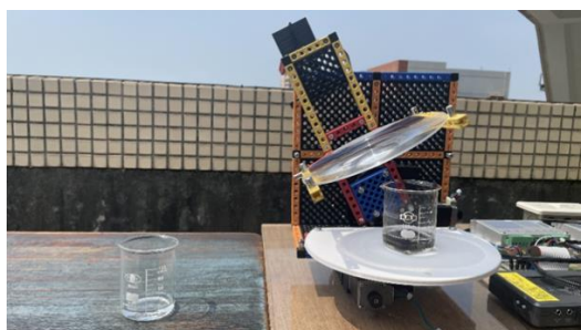
圖（43）有追日系統加熱實驗照片
