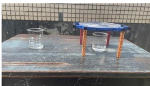
圖（41）有菲涅爾透鏡時加熱實驗照片
