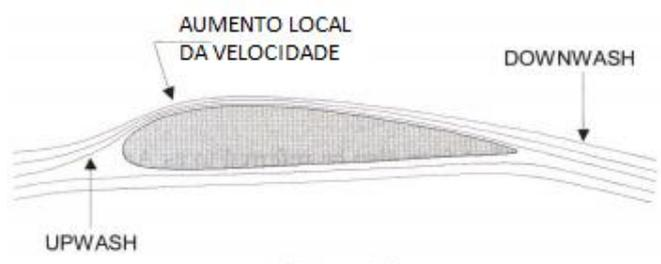
圖 6 下洗氣流 Downwash 示意圖[20]
