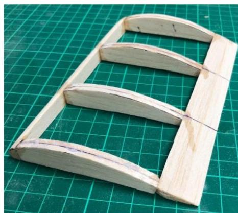
圖 24 NACA6312 翼型剖面圖[28]/ 機翼製作照片
