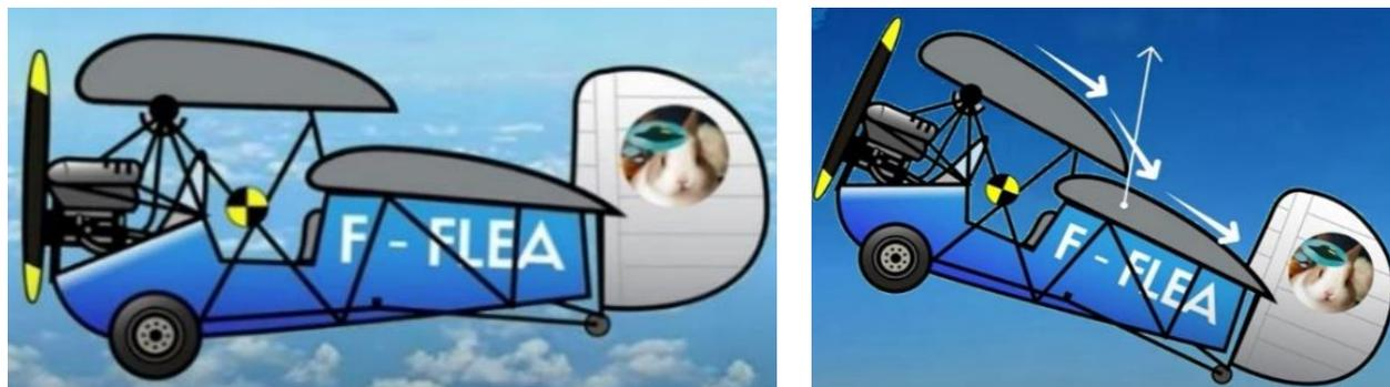
圖 7 跳蚤飛機下洗流示意圖[21]
