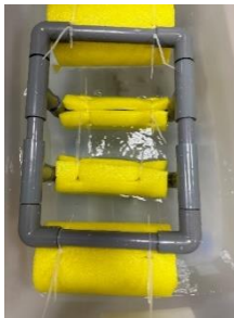
(圖十六)PVC 與浮力結構
