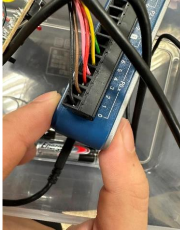
(圖十) 多功能 I/O 介面卡的輸出訊號線
