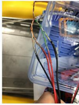
▲將電線個別用防水套管套住加熱
