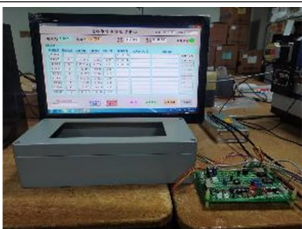
圖 5-29(A)照明設備故障自動修護系統
