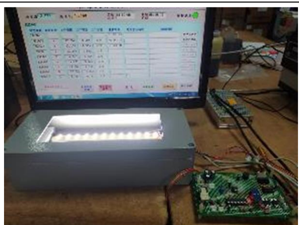
圖 5-29(B)照明設備故障自動修護系統
