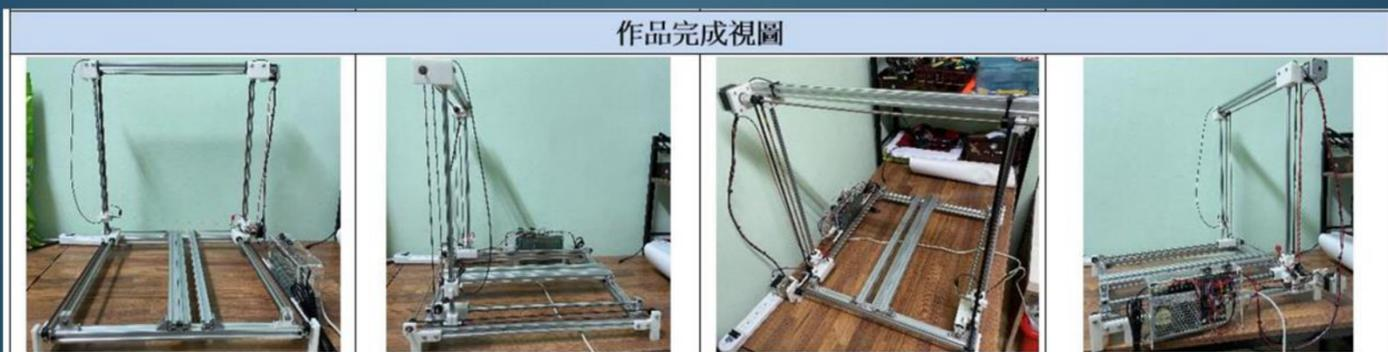
第一代機器完成圖，可切割的最大尺寸為39(寬)\*40(高)\*30(厚)cm。
