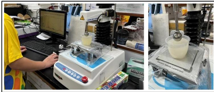
圖 7 以物性測定儀進行樣品質地剖面分析。
