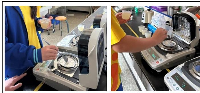
圖 9 以紅外線水分分析儀測定樣品水分含量。
