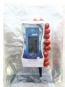
圖 5 於密閉空間中利用二氧化碳監測儀監測二氧化碳濃度變化
