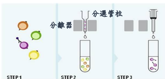
圖二：MACS 的原理 Step1 奈米磁性顆粒和表面抗原專一性結合
