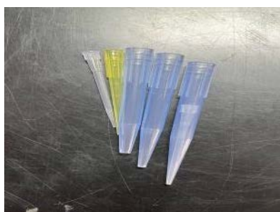
圖八、微量滴管管套（由右至左：藍頭未剪、藍頭剪 0.5cm、藍頭剪 1.0cm、黃頭、白頭）
