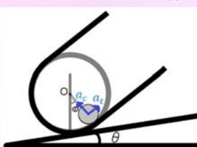
圖6(a) 鋼珠加速度示意圖
