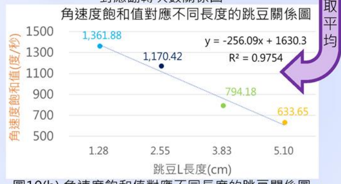
圖10(b) 角速度飽和值對應不同長度的跳豆關係圖 跳豆越長飽和角速度越小，幾乎為線性關係。
