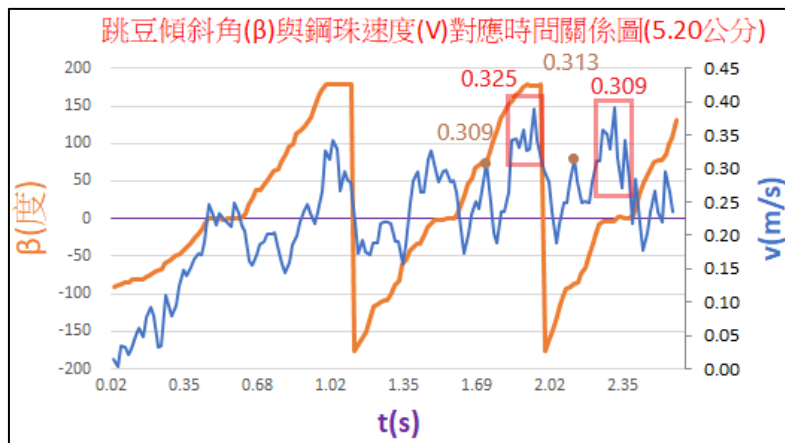
圖四十一、鋼珠速度平均值取樣說明
