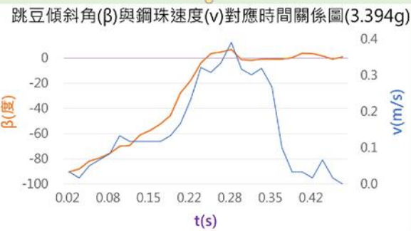
圖18(a) 內球質量 3.394 g 的跳豆傾斜角(beta)與鋼珠速度(v)對應時間關係圖
