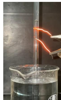
圖 2. 波紐的熱管裝置照片
