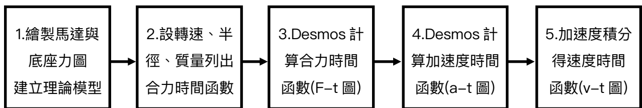
圖 9.利用理論模型計算旋轉振動體水平速度的理論計算流程圖
