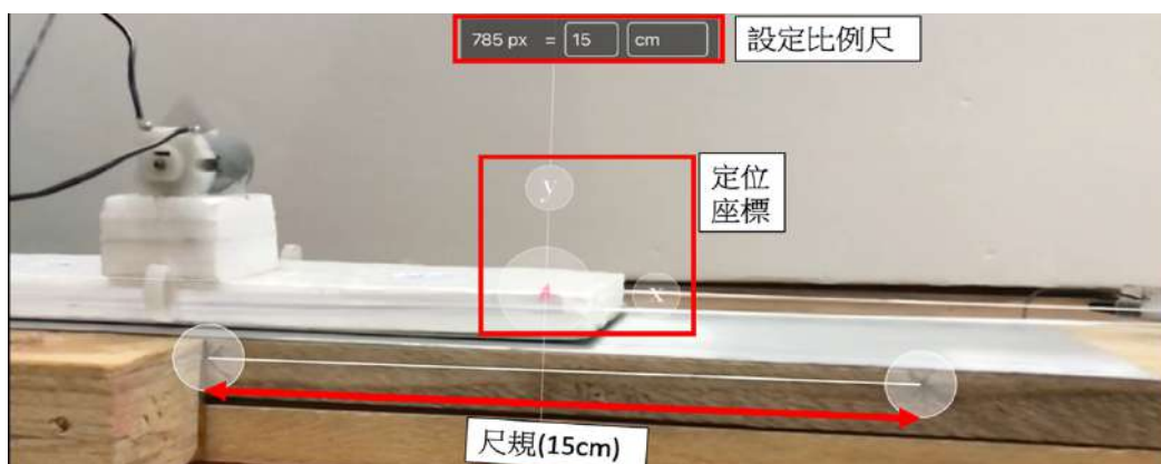
圖 5. 在木板上先量好一段長度，並在欲追蹤物體上放置一明顯標記物，拖曳軟體中的尺規工具使其吻合先前量的長度，並將比例尺設定為量好的長度，再把座標對準標記物並調整調整角度使 x 軸與前進方向平行。
