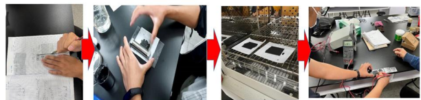
圖5、定量石墨導電膠以刮刀塗抹法來比較不同石墨厚度電阻值。
