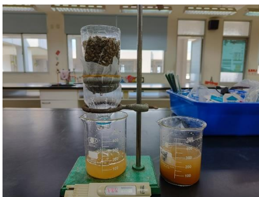
圖十三：麥飯石、活性碳綿的水質淨化效果實驗裝置圖
