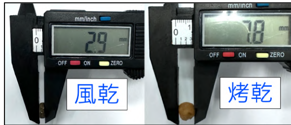
圖十七 風乾的飼料無膨脹現象（左）。經烘烤後的飼料發生膨脹現象（右）。
