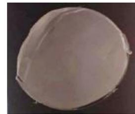
圖 1-3-3 海藻酸鈉和澱粉混合薄膜
