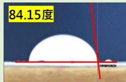
圖3: 接觸角測量結果
