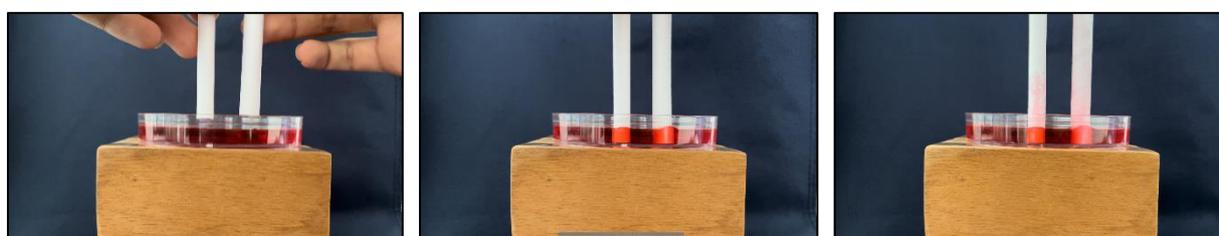
圖 3-3-9-2：紙吸管的吸水實驗，35 分鐘後吸滿
