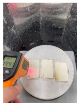
圖 3-3-7-2：添加浸泡纖維素的酸製成的明膠紙膜，在 174°C 變色
