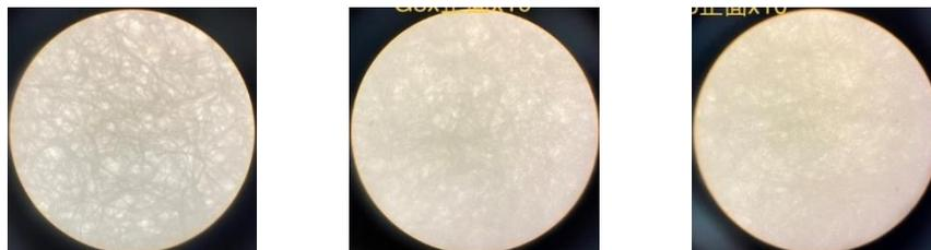
圖 4-1：顯微鏡下噴膠後的濾紙照片(40×10)，左為未噴膠
