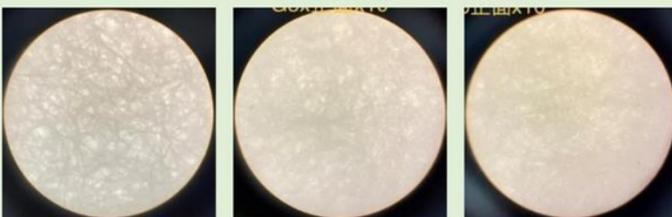
圖13 左：為未上膠膜的濾紙，其纖維孔隙較明顯；中：是只噴上明膠膜，孔隙略為較少；右：是在明膠中添加浸泡稻殼粉的檸檬酸，孔隙更為稀少
