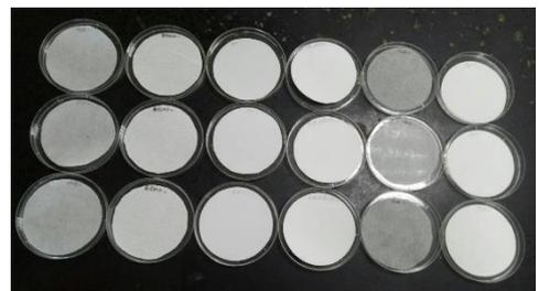
圖 3-3-7-1 噴膜在不同紙張上，進行防水實驗的測試
