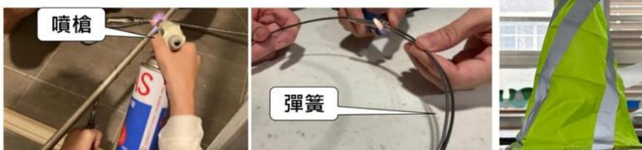
圖3-2-1燒製金屬線 圖3-2-2固定角錐彈簧底部 圖3-2-3 第二階段角錐成品
