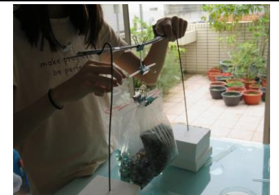
圖 39.測抗張力時,不斷放入彈珠,一直到藻紙條斷裂為止
