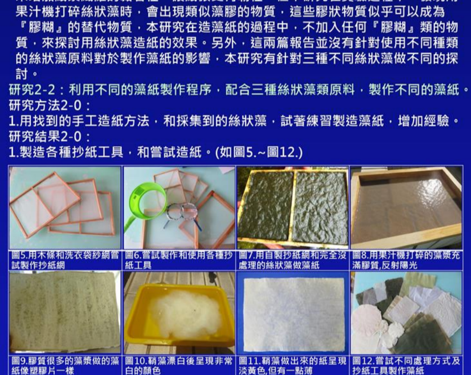
圖5.用木條和洗衣袋紗網嘗試製作抄紙網 圖6.嘗試製作和使用各種抄紙工具 圖7.用自製抄紙網和完全沒處理的絲狀藻做藻紙 圖8.用果汁機打碎的藻類充滿膠質,反射陽光 圖9.膠質很多的藻漿做的藻紙像塑膠片一樣 圖10.鞘藻漂白後呈現非常白的顏色 圖11.鞘藻做出來的紙呈現淡黃色,但有一點薄 圖12.嘗試不同處理方式及抄紙工具製作藻紙
