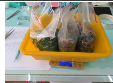
圖 40.藻紙條斷裂後,測量袋中所有珠璃彈珠的總重量
