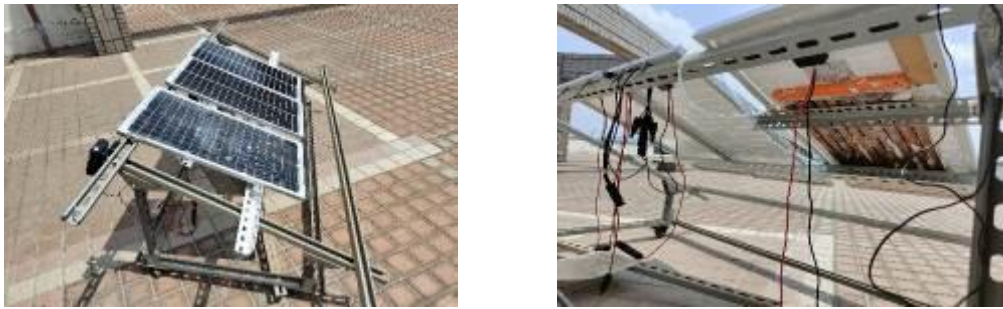
圖四十四、有無降溫之太陽能板發電功率比較之實驗架設圖
