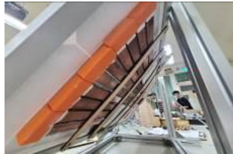
圖十三、完成連接之冷卻管路擺放位置
