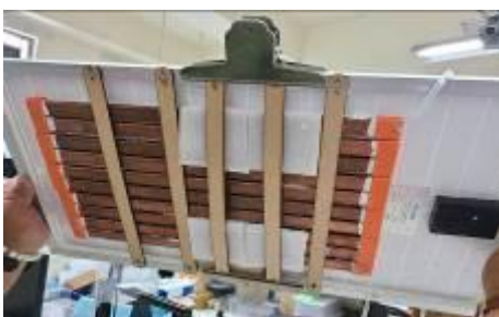
圖十八、固鎖密集板支架狀態
