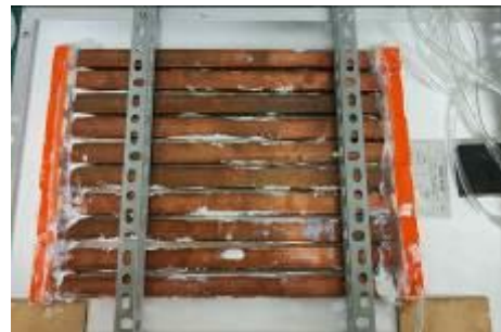
圖二十三、固鎖角鋼支架
