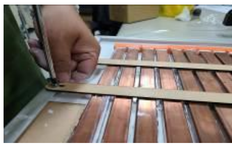
圖十七、固鎖密集板支架
