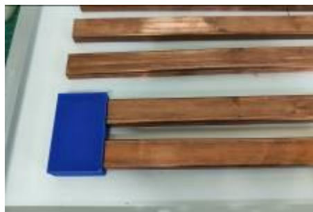
圖八、銅管塞入轉接結構(未密封阻水)
