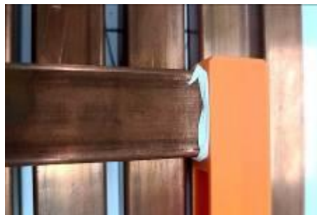
圖十、銅管塞入轉接結構(膠布密封阻水)
