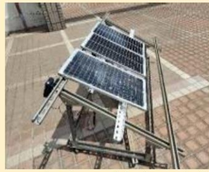
圖三十八、有無降溫之太陽能板發電功率比較之實驗架設圖
