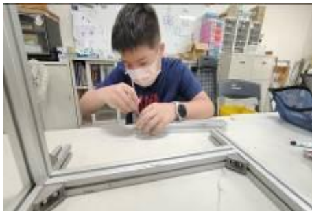
圖二十、鋁擠型支架組合安裝
