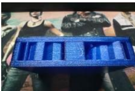
圖五、3D 印表機製作結構支撐
