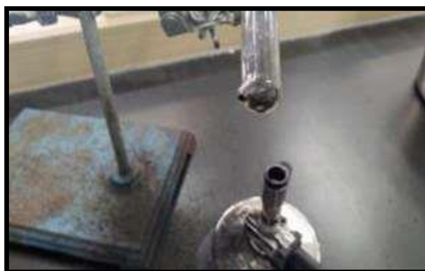
照片 92：第二次煉鐵，硬試管燃燒後仍變形
