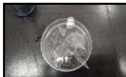
照片 64：鐵粉溫度過高造成 錶玻璃破裂
