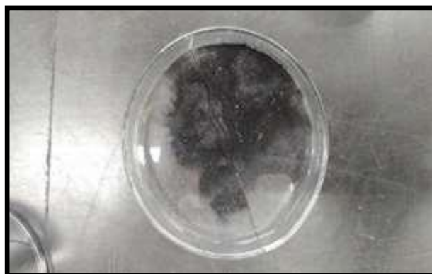
照片 107：第十一次煉鐵，有塊狀鐵渣產生
