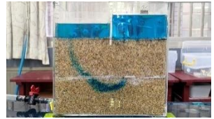
圖66. 有隔水層的A'a' 流線路徑（無抽水）
