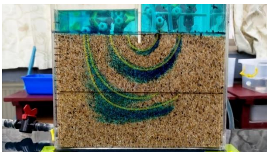
圖72. 無隔水層的流程（無抽水，疊圖）
