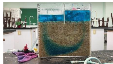
圖34. 25°C 清水的Cc流線路徑
