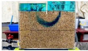
圖57.無隔水層的Bb 流線路徑（無抽水）
