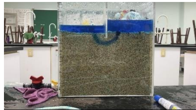
圖48. 30°C 清水的Aa流線路徑
