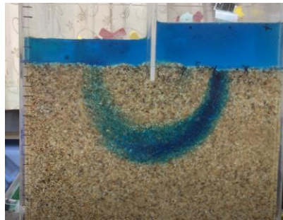
圖43. 15°C 清水的Bb流線路徑
