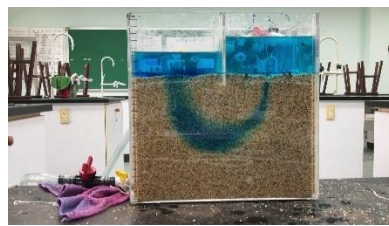
圖33. 25°C 清水的Bb流線路徑
