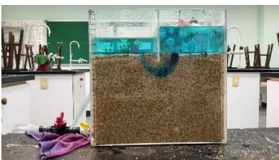
圖32. 25°C 清水的Aa流線路徑
