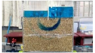
圖65. 有隔水層的Bb 流線路徑（無抽水）
