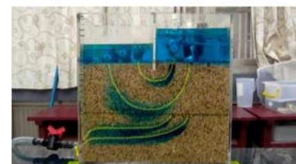
圖73. 無隔水層的流線 (有抽水, 疊圖)
