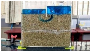
圖68. 有隔水層的Aa 流線路徑（有抽水）
