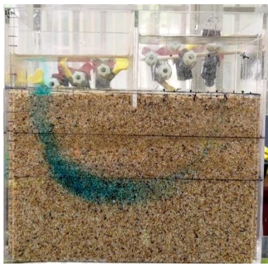
圖24. 0.1 ml染料測試結果
