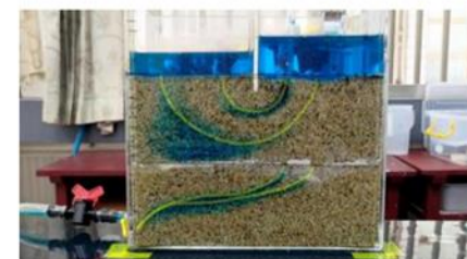
圖75. 有隔水層的流線 (有抽水, 疊圖)
