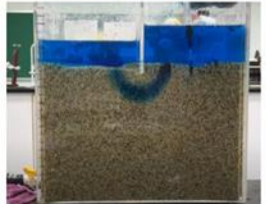
圖45. 20°C 清水的Aa流線路徑
