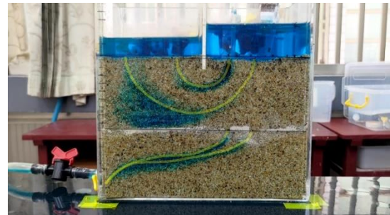
圖75. 有隔水層的流程（有抽水，疊圖）
