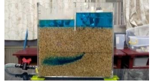
圖62.無隔水層的A'a' 流線路徑（有抽水）
