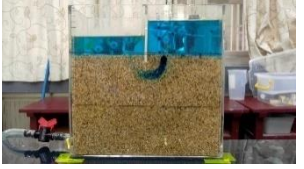
圖60. 無隔水層的Aa 流線路徑（有抽水）
