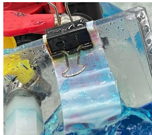
圖19. 入水孔分散水流裝置
