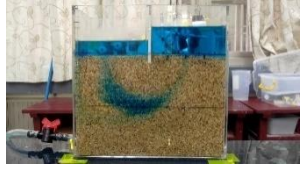
圖61.無隔水層的Bb 流線路徑（有抽水）
