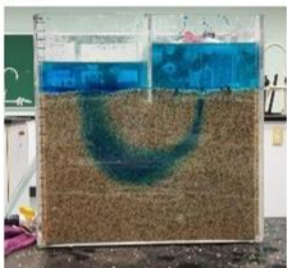
圖33. 25°C 純水的Bb流線路徑
