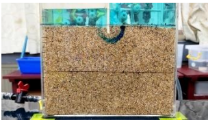
圖56. 無隔水層的Aa 流線路徑（無抽水）
