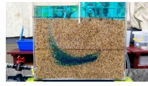
圖59.無隔水層的B'b' 流線路徑（無抽水）
