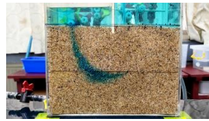
圖58.無隔水層的A'a' 流線路徑（無抽水）
