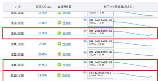
圖83. 屏東平原觀測井的地下水位歷線圖(2022/6/13至2023/6/13)
