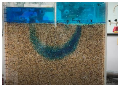
圖38. 35‰鹽水的Bb流線路徑
