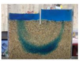
圖44. 15°C 清水的Cc流線路徑
