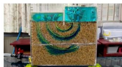
圖74. 有隔水層的流線 (無抽水, 疊圖)
