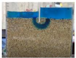
圖42. 15°C 清水的Aa流線路徑
