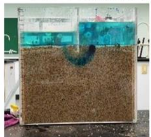
圖32. 25°C 純水的Aa流線路徑
