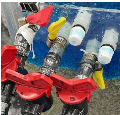
圖18. 入水孔控制流量用球閥
