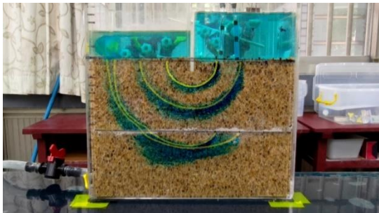
圖74. 有隔水層的流程（無抽水，疊圖）
