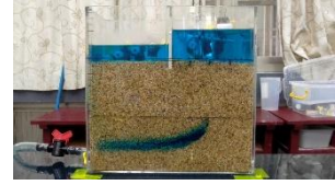
圖63.無隔水層的B'b' 流線路徑（有抽水）
