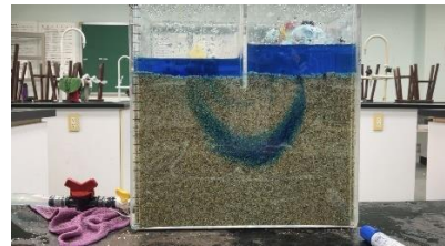
圖49. 30°C 清水的Bb流線路徑
