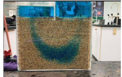
圖50. 30°C 清水的Cc流線路徑
