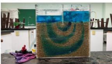
圖79. 25°C 清水的流線(後製合併)
