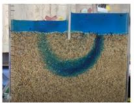
圖43. 15°C 清水的Bb流線路徑
