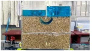
圖64. 有隔水層的Aa 流線路徑（無抽水）
