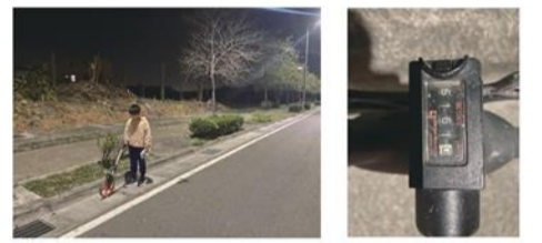
圖4-11、利用測距輪測量道路的距離
