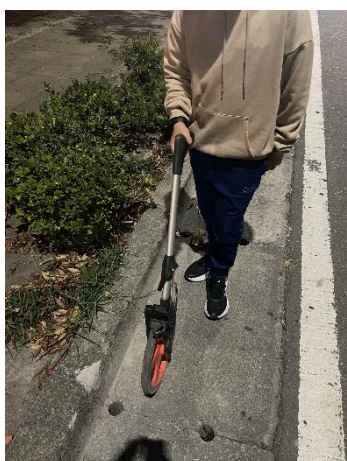
圖 4-11、利用測距輪測量道路的距離
