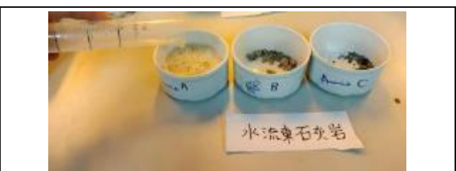
圖 6-3. 此為水流東石灰岩的樣本，最左邊的樣本為滴入鹽酸後冒泡的狀況。
