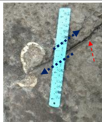
圖 5-13. 由右圖可以觀察到上層的石灰岩層出現了數條近乎平行的裂縫，其中比較清楚可見的兩條裂縫如紅色箭號指出的位置，我們在其中的一條裂縫處發現了海膽化石被裂縫切過的現象，如右圖所示，由此可以推測這些裂縫應該是斷層所造成的。圖 5-12 出現的張力裂縫，如左圖中的黃色箭號所示，與斷層造成的裂縫，兩者呈現一個夾角關係。
