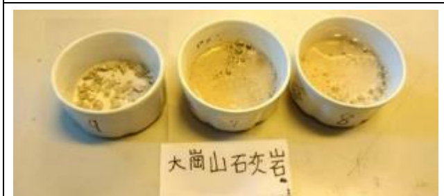
圖 6-4. 此為大崗山石灰岩的樣本，中間與最右邊的樣本為滴入鹽酸後冒泡的狀況。
