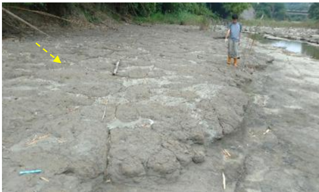
圖 5-12. 從左上張圖中的黃色箭號指出有出現一條長長裂縫，而且一直延伸到河流，如右圖近距離觀察裂縫的寬度大約 5~10cm，因為裂縫有呈現開口狀，所以推測應該是張力裂縫。
