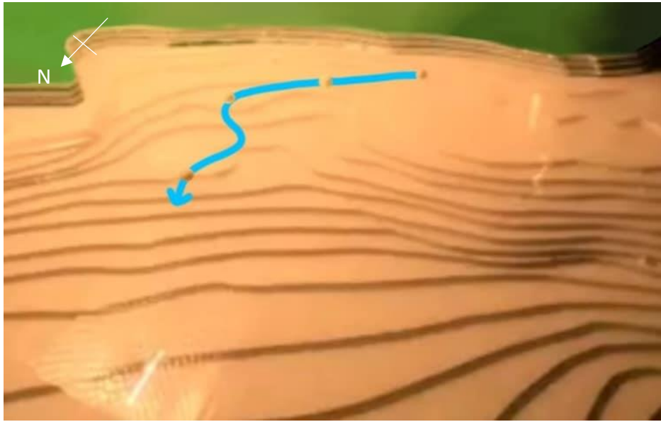
圖十九、保麗龍球在沙崙海水浴場海底立體模型中隨著西南方進入的水流移動路徑
