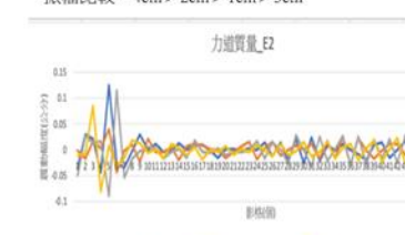
圖4-2-10 (0.8g)不同力道的 質量C的震動情況 振幅比較：4cm>2cm>1cm>3cm
