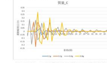
圖4-2-6 (4cm)不同獵物重量 質量C的震動情況 振幅比較：0.8g>0.2g>0.4g>0.1g
