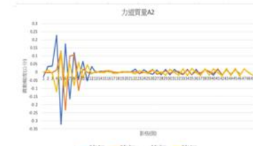
圖4-2-9 (0.8g)不同力道的 質量A的震動情況 振幅比較：4cm>3cm>1cm>2cm
