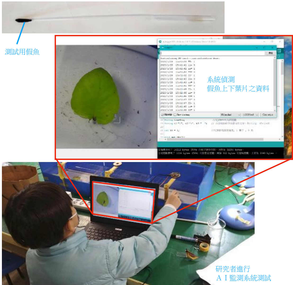
圖 18 蓋斑鬥魚攀葉行為 AI 監測系統測試
