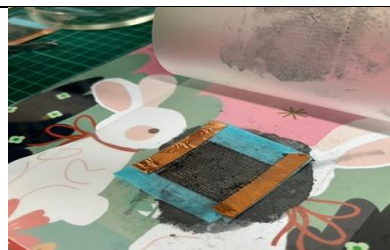
實驗六-2 過篩後鋅粉先鋪平，蓋上 F_1 \sim F_3 棉格柵後以投影片蓋住，以玻棒來回滾壓數次
