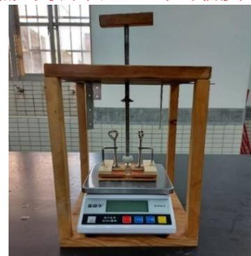
▲圖11 自製韌度測量儀
