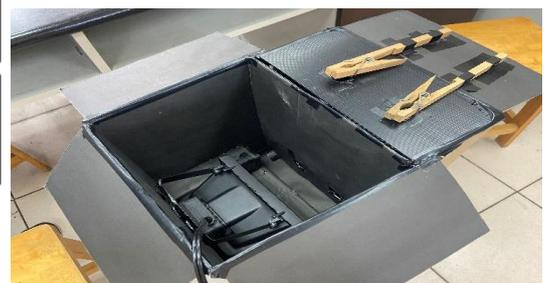
▲圖22 測量隔熱率
