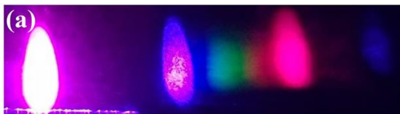
圖4.(a)以手機讀取的螢光光譜照片圖。(b)以Tracker程式數位化照片所得的螢光光譜圖。
