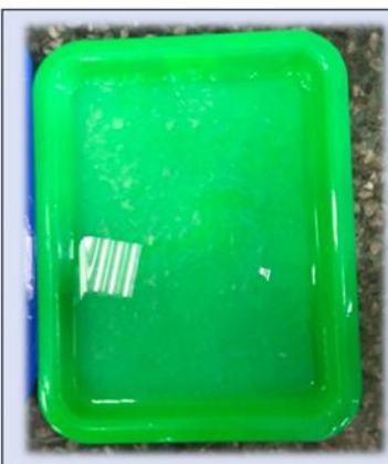
圖1. 未完成交聯作用的海藻酸鈉薄膜
