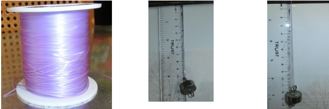
圖 1 確定實驗所需彈力串珠繩彈性係數
