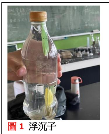
此外在實驗過程中我們觀察到壓力越大，浮沉子吸管中空氣體積便愈小，經請教老師，老師叫我們上網查「波以耳定律」，於是知道這是波以耳定律描述的現象，也就是說：**在定溫下，定量氣體體積和壓力成反比。**
