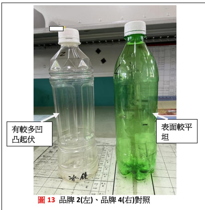
我們使用的C形夾施力主要來自其施力盤，但不同的瓶子表面受力時分散受力面積的效果不同。這就像是在爛泥地上墊著一塊大木板踩下去，陷下去就不深，因為木板分散受力面積使得壓力減小，但若墊著一塊相同面積的軟布，則分散受力面積的效果就差很多。當C形夾的施力盤壓上去時，有些瓶子的表面像木板，有些瓶子的表面則像軟布，因而產生大小不同的壓力。
