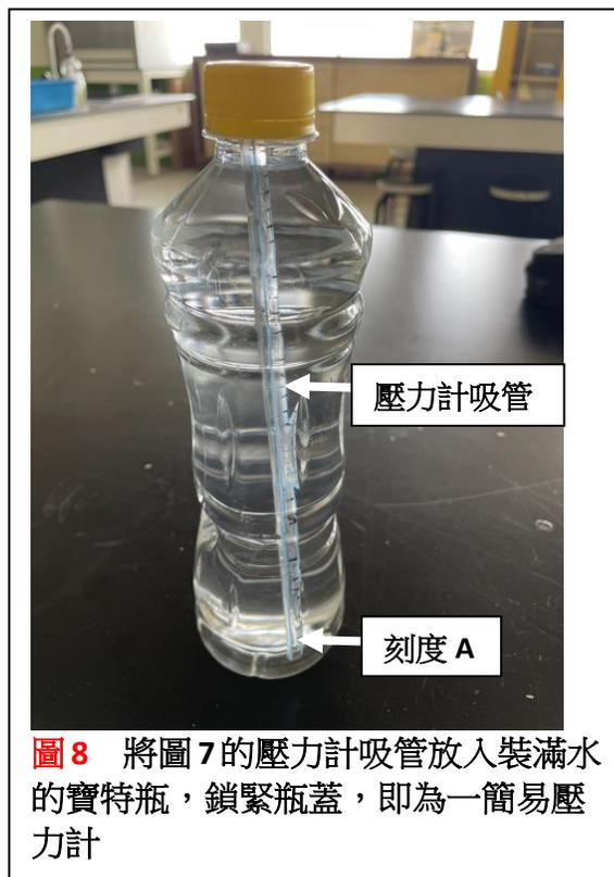
(4)量測寶特瓶所受壓力時，只需紀錄未施壓前吸管中空氣底部所在**刻度 A(圖8)**，對寶特瓶以C形夾施力後，吸管中水位會上升，此時再紀錄吸管中空氣底部所在**刻度 B(圖9)**。
