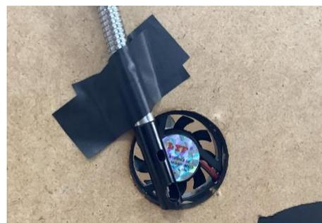
圖 3-2-3 熱線式風速計固定於風扇前
