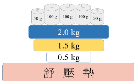
圖三 4.4kgw 槓片與砝碼擺放示意圖
