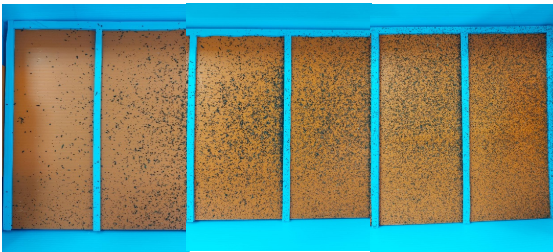
圖 7、茶葉顆粒分布圖（由左至右顆粒分別為大到小，取最後三格為實驗測定茶葉）
