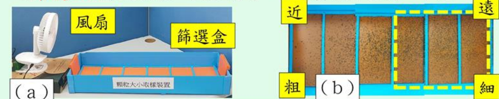
圖2、(a)茶渣風選裝置, (b)取樣結果
