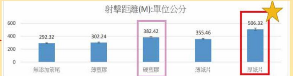
圖22: 不同添加不同材質(紙片及塑膠)於箭尾對於鳥羽弓箭射擊距離影響
