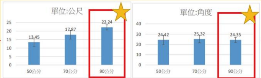
圖14: 不同長度對於射擊距離影響 圖15: 不同長度對於射擊準確率影響
