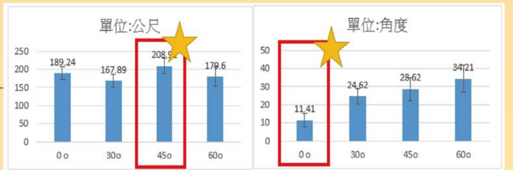
圖20: 不同射擊仰角對鳥羽箭射擊距離影響 圖21: 不同射擊仰角對鳥羽箭準確值影響
