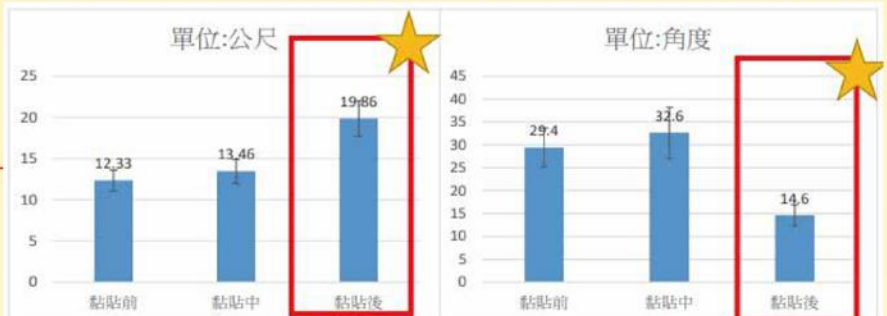
圖18: 鳥羽黏貼位置對於射擊距離 圖19: 鳥羽黏貼位置對射擊準確率影響
