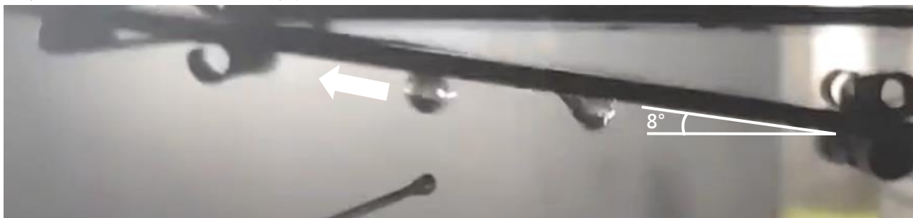
圖 5-14-6 懸吊水滴爬坡分身圖 (8°爬坡)
