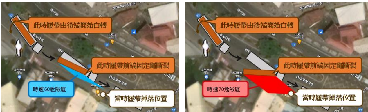
圖 44 車輛時速 60km/h(速限)，時速 70km/h，(超速)，甩出前受板台摩擦力影響示意圖
