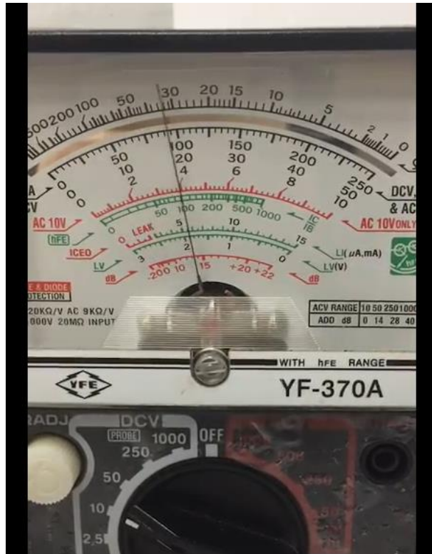
圖 5-6-2 太陽能光電板電壓實測
