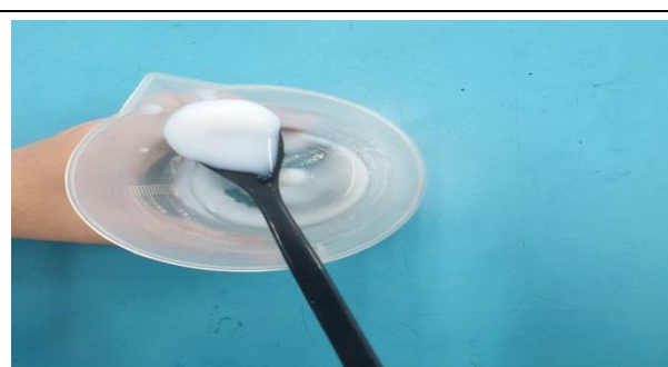
圖 2 二氧化矽和水混合成凝膠狀示意圖
