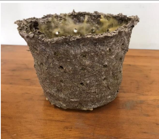
圖 12 吸水環保花盆外盆鑽孔加工圖
