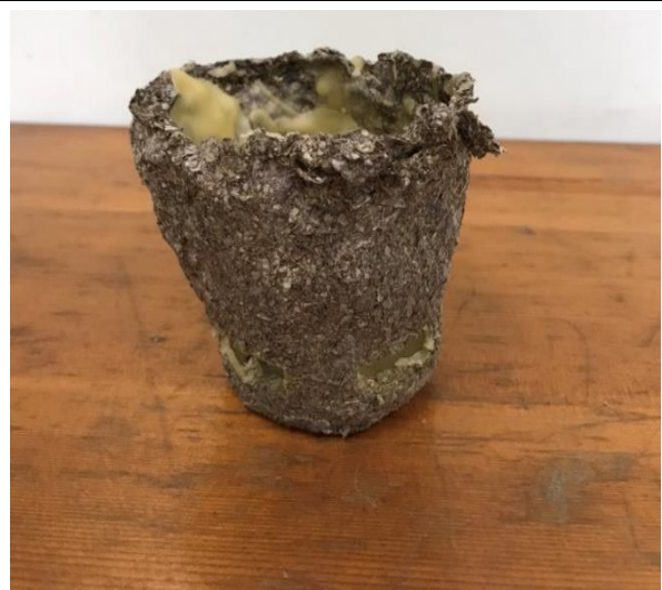
圖 13 吸水環保花盆內盆挖洞加工圖
