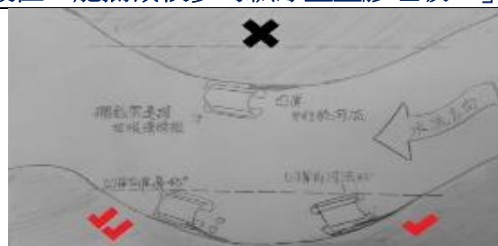
圖四十五、攔截索連結垃圾清除船在凹岸凸岸位置比較示意圖
