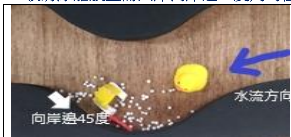
圖四十四、攔截索連結垃圾清除船在凹岸向河流45度角位置的攔截較佳
