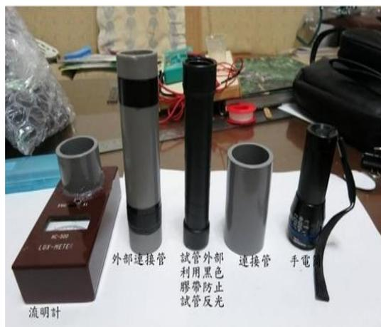
2. **實驗設計：**參考以上作品，先行畫出設計圖，依以下步驟，**自製流明度檢測器**，並**自製亮度感測器**，輔以電腦檢測 Arduino 光敏電阻數值，驗證其準確度。
