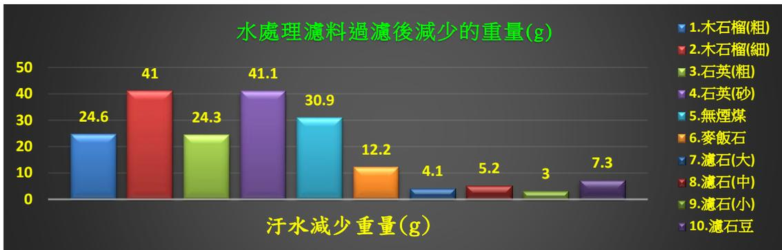
從實驗結果可以發現過濾後，水處理濾料汗水減少重量大多偏少，而其中重量減少稍多的是木石榴(細)、石英(砂)、無煙煤。
