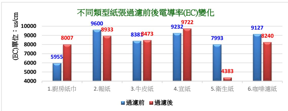
1. 結果：實驗發現廚房紙巾過濾前後，電導率(EC)數值上升最多，衛生紙及咖啡濾紙數值明顯下降。
