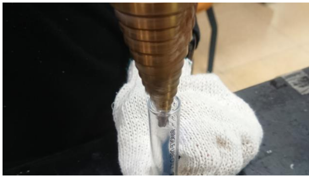
把兩個針筒前端剪掉，用電鑽鑽出大孔洞。
