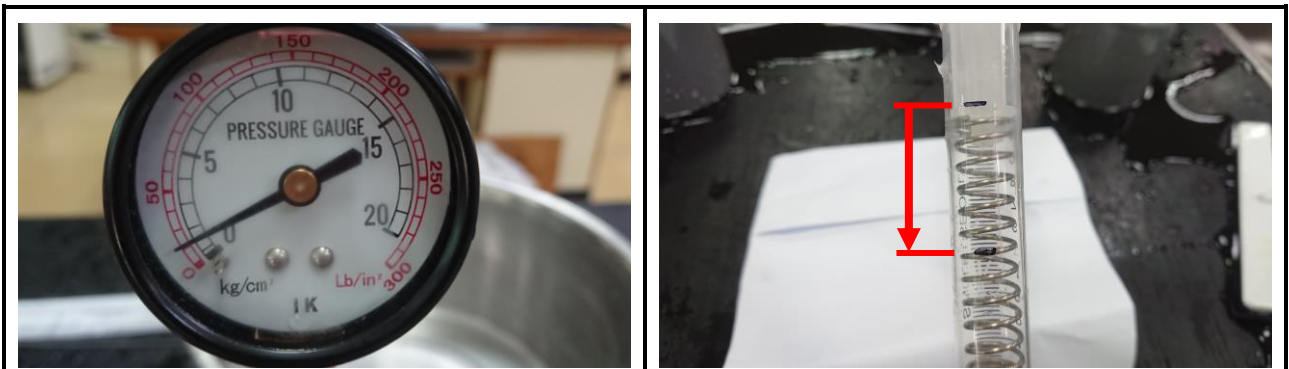
水壓 1.5 \text{ kgw}/\text{cm}^2 時，兩者的變化情形。
