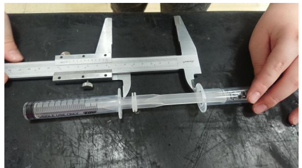
準確測量兩支針筒間的距離，這樣中間的支架塑膠管才不會擠壓到彈簧。
