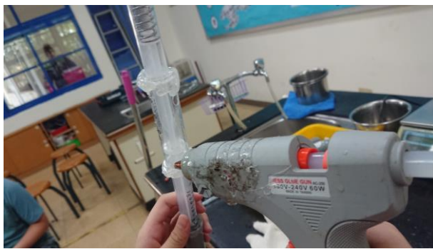
用熱融膠把中空塑膠管、兩個針筒黏在一起
