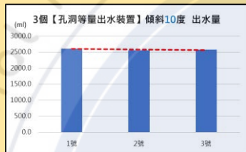
不同傾斜角度 最大水量差距 85.9% → 15.7%
