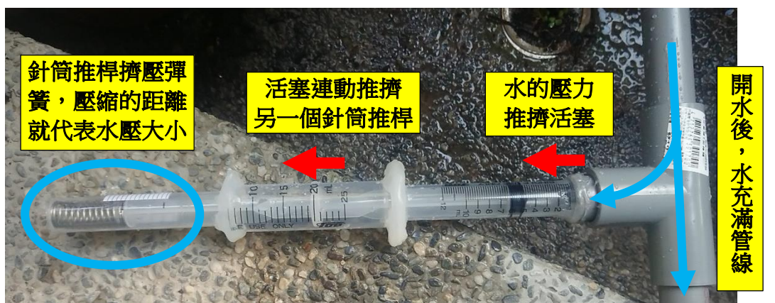
整套裝置黏在 PVC 水管上，可換裝在粗的或細的 T 型管上，進行實驗。
