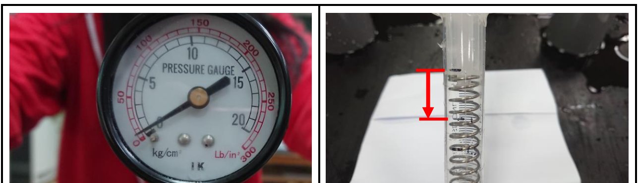
水壓 1 \text{ kgw}/\text{cm}^2 時，兩者的變化情形。
