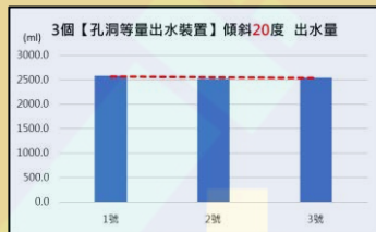
不同傾斜角度 最大水量差距 85.9% → 15.7%
