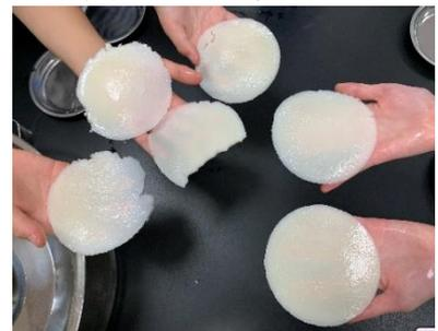
圖 4-4-24 測試後自模具取出的板條
