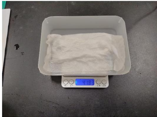
圖 4-2-12 用電子秤測量記錄吹風後塑膠盤的重量，並計算水分蒸發的重量(1g=1 ml)
