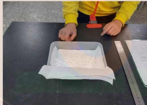
圖 4-2-5 將棉線彎折成 15 cm\*2 條，放置在要包覆材質的上面
