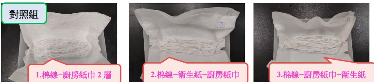
圖 5-10-1-1 複合式材質包覆順序：1.棉線-廚房紙巾 2 層(對照組)、2.棉線-衛生紙-廚房紙巾、3.棉線-廚房紙巾-衛生紙
