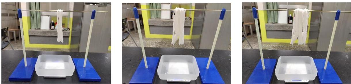
圖 5-4-2-2 微溼、過溼環境：棉線 40、80、120 條在加溼 45、90 ml 後滴水 3 分鐘的滴水量
