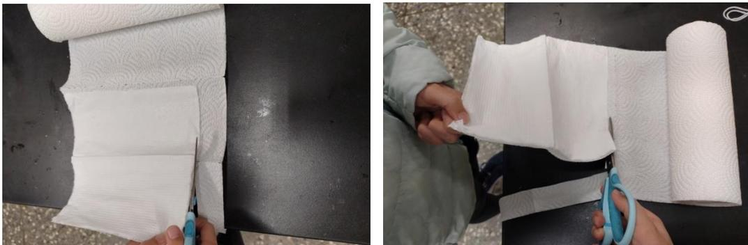
圖 6-1-1 為了求各個材質的接觸面積(20\*19cm)一樣，使用的溼紙巾、廚房紙巾、衛生紙、不織布都要經過修剪，以求實驗的標準一致
