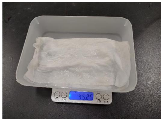
圖 4-2-10 用電子秤測量記錄吹風前塑膠盤的重量
